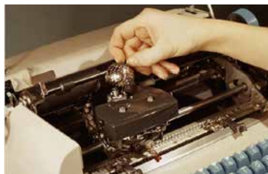
Рис. 3. Набор сменных головок: а) для печатной машинки Selectric II; б) удобство выбора и лёгкость замены шрифтов [16]
